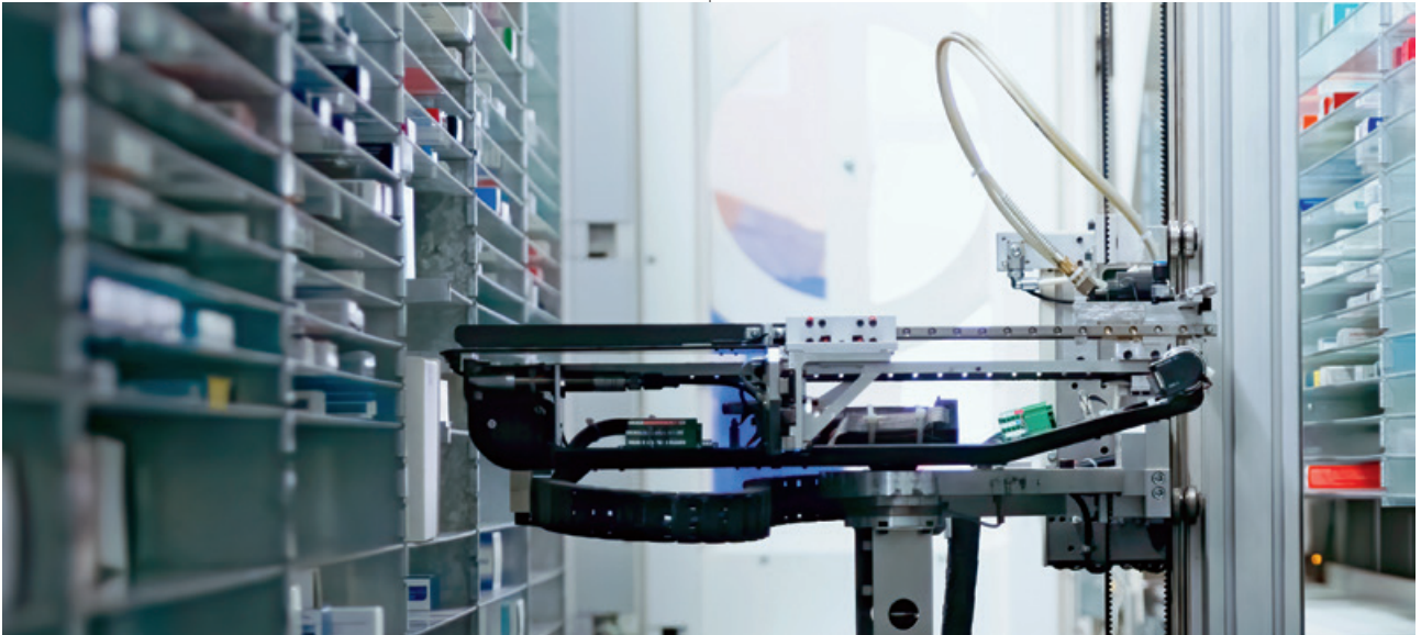
Robot RIEDL Phasys, uno dei più evoluti sistemi di automazione per la distribuzione dei farmaci
