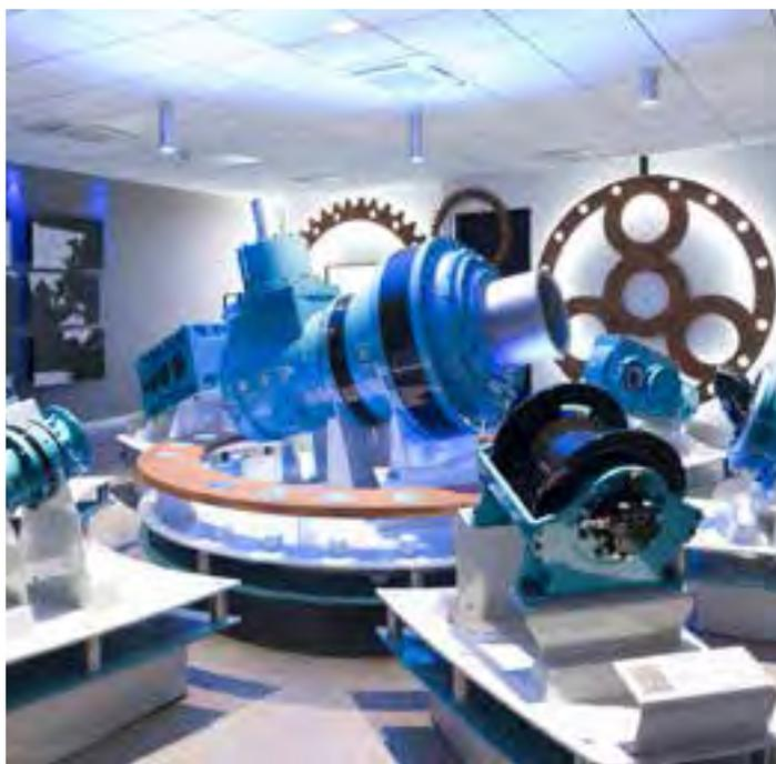
Tutti i 34 riduttori ad assi paralleli forniti da Brevini, che aprono e chiudono le paratoie, dovranno durare 35 anni senza guasti, per un totale di oltre 57.000 ore lavoro.
